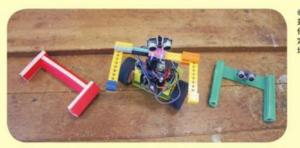
於設計外,劉老師提醒有興趣學習類似方案的人,也可留意整項設計 無論是由底部至機械手的部分,除Arduino是固定硬件外,可以更換任何物 料組裝,如Lego、立體打印等,不限於亞加力膠片,剛校選擇用亞加力膠 片的原因是能快速製作,方便教學,建議選用身邊已有的資源或物料已可。
